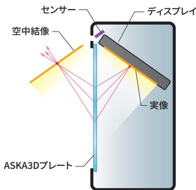
画像の光が「ASKA3Dプレート」内で反射して、プレートの反対側の等距離の位置に空中結像した高精度な映像を表示します。
