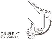
開閉時は必ず本体を動かしてください。ロック解除金具 を引っ張り、開閉すると故障の原因になります。
