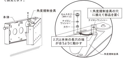
② 角度規制されているか開閉確認後、 金具をしっかりと奥まで押し込みます。
