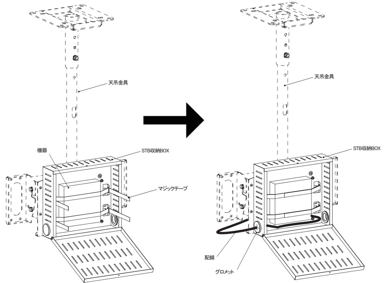
5. 収納後、パネルを上げて、取り外したツマミを取り付けます。
