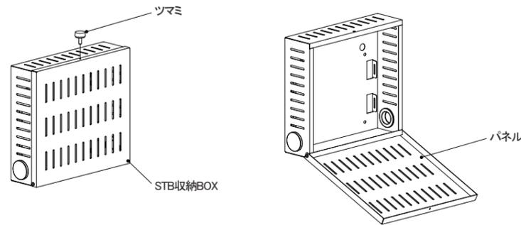
2. STB収納BOX上部のツマミを外し、パネルを開けます。
