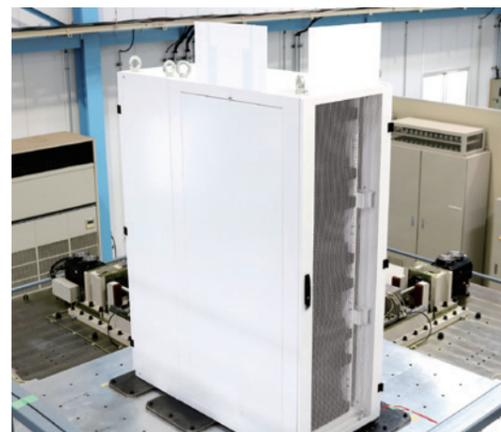
【FSR-DER7200E】1000gal実験(1000kg搭載)▶
