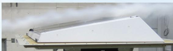
風洞試験にて移動のズレ、破損等の異常が無いことを確認。
