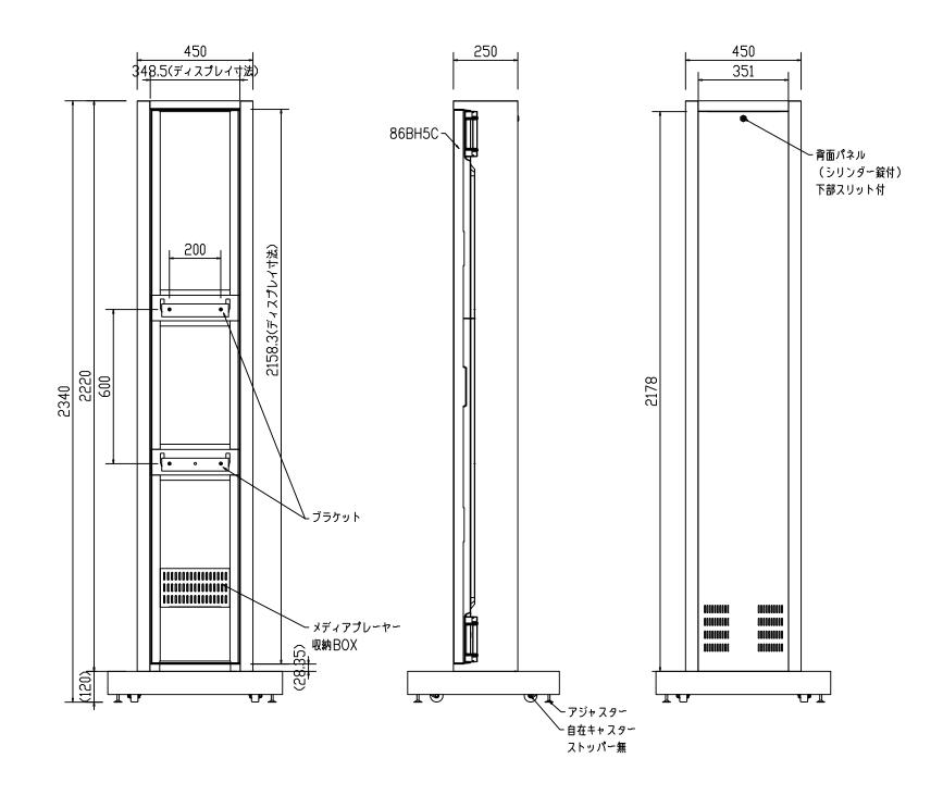
塗装色:サテン黒(焼付塗装) 使用モニター:86BH5C 約20.5kg (W348.5 H2158.3 D81.7) 添付品(1台あたり) ナベセムス(P=3) M8×25 ×4本 バインド小ネジ M4 X 1 O ×4本 六角穴付き(P=3) M8×20 ×4本 六角穴付き(P=3) M8×20 X8本 六角穴付ボルト M10X30 X6本 平ワッシャー M 1 O ×6個 スプリングワッシャー M10 ×6個 Lレンチ 対辺6mm × 1個 Lレンチ 対辺8mm × 1個 OAタップ:2口・15A125V・コード3m ×1本
