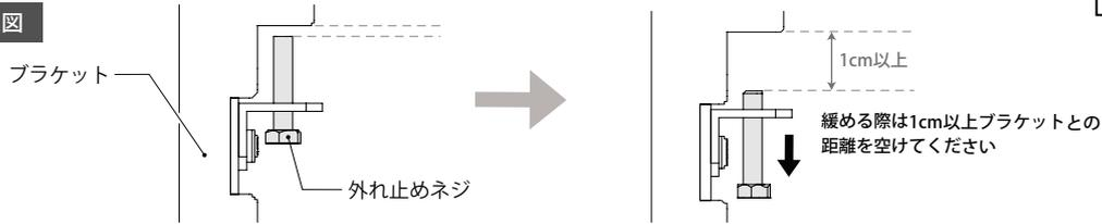
2. 緩みを確認してから「ブラケット受け」の取り付け側上部の「落下防止ネジ」を外します。
