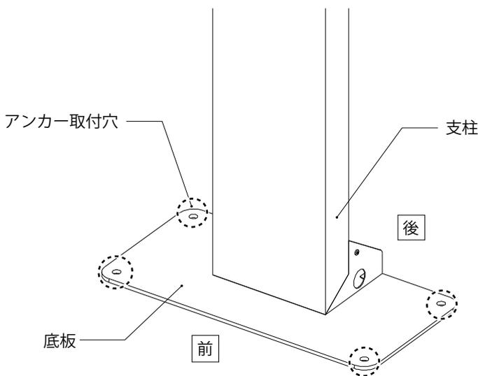
アンカーボルトの打ち込み位置は、計4箇所
