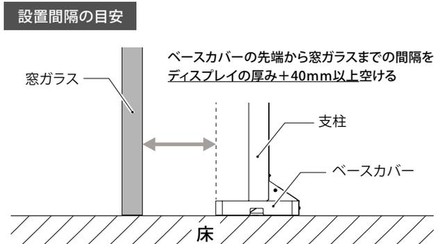
⚠ 確実にアンカーボルトを取り付けてください。スタンドの転倒による破損・けがの原因となります。
