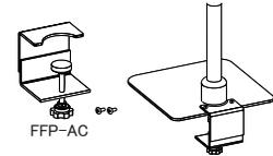
スタンドのベースに取り付けて、ダブルスタンドを机に固定します。(ネジ M6×12 2本付き)
