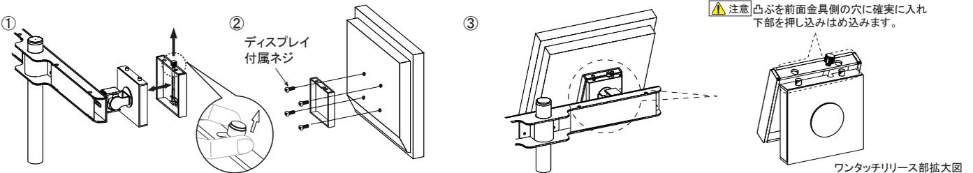
①アーム前面部分のワンタッチリリースを外します。前面上部つまみを上に引き上げ、ワンタッチリリース部を分割させます。
